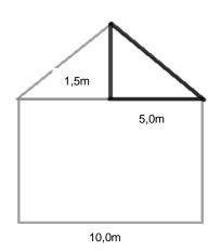
Nota-se que há a formação de um triângulo retângulo, utilizando o teorema de pitágoras  $a^2 = b^2 + c^2$ , podemos determinar a largura de um lado do telhado.
