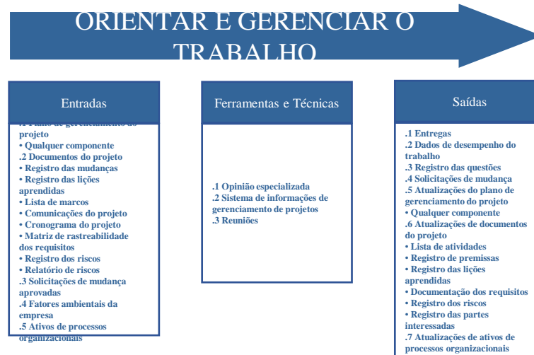
Figura 10-6. Orientar e Gerenciar o Trabalho do Projeto: Entradas, Ferramentas e Técnicas, e Saídas
