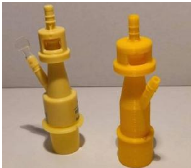
Figura 5: Válvula original (à esquerda) e sua cópia obtida na impressora 3D (à direita)
