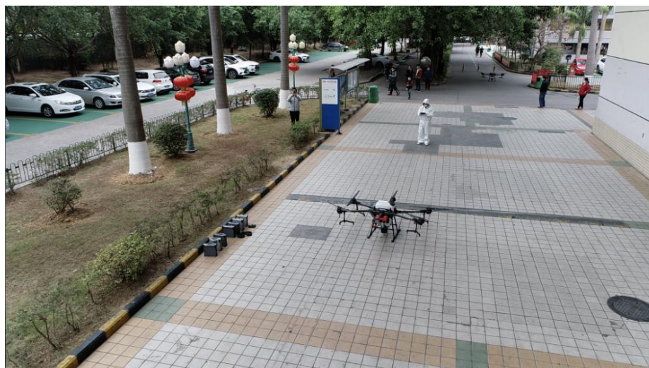
Figura 7: Drone sendo utilizado para esterilização dos espaços públicos chineses
