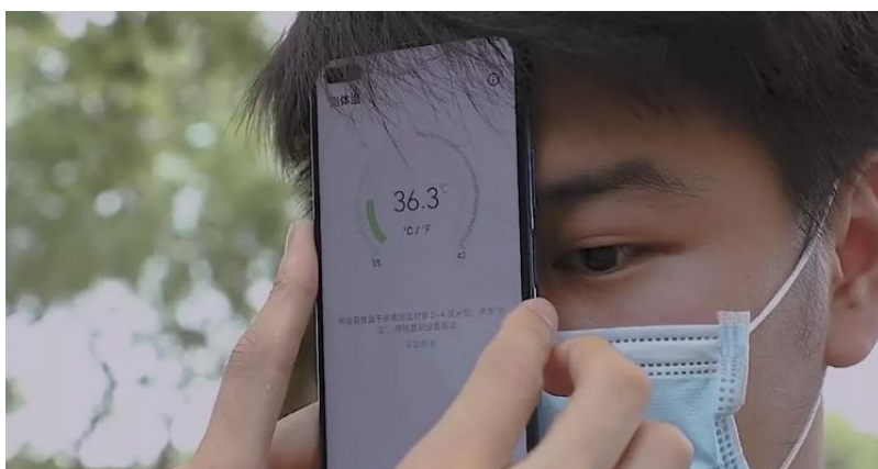
Figura 9: Exemplo de uso do celular com sensor infravermelho para medição da temperatura corporal
